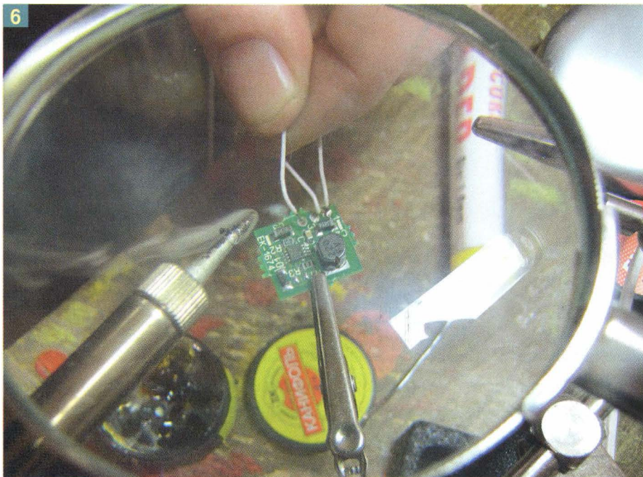
6 Не простое дело — пайка проводов к миниатюрному устройству.
