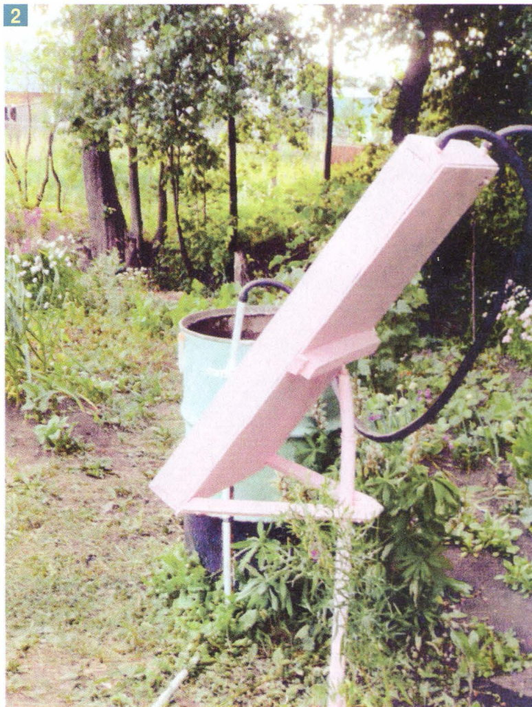
2 Крепление теплообменника позволяет ему поворачиваться вокруг вертикальной оси, а треугольная рамка исключает опрокидывание.
