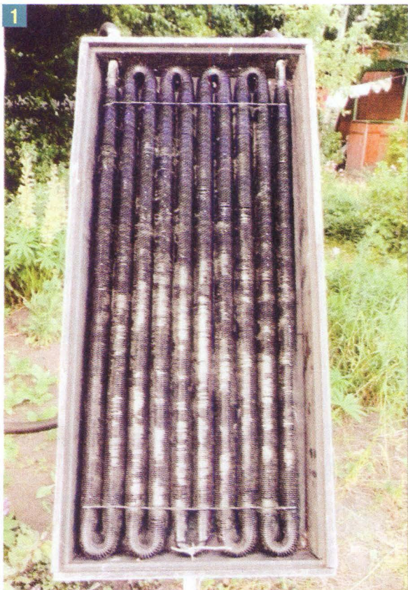
1 Батарея, которая служит теплообменником, закреплена в самодельном ящике.
