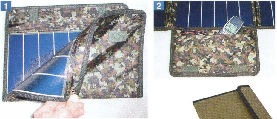
1 Гибкая панель солнечной батареи из аморфного кремния. Батарею можно свернуть в рулон или сложить в несколько раз.
