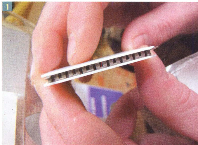
Рис. 1. Термосборка Пельтье-Зеебека из полупроводниковых (n- и p-проводимостей) элементов.
